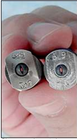
Bico novo e desgastado
