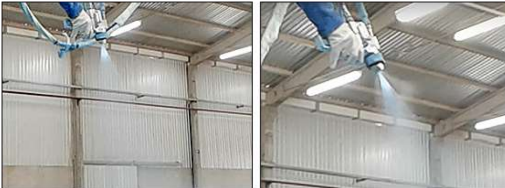
Aplicação com airless aberto, em bom funcionamento, garante mistura perfeita do catalisador ao gelcoat. À direita, airless com problema (note a névoa de catalisador se perdendo no ar).
