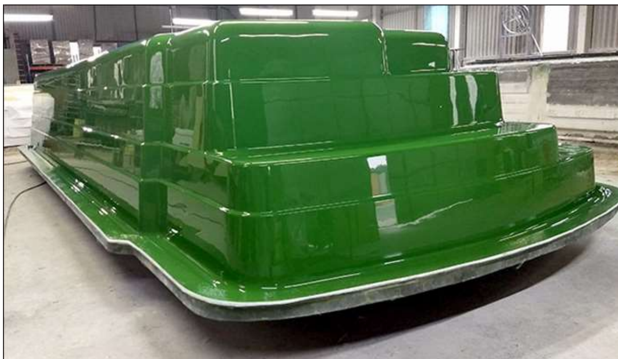
Molde de piscina feito com gelcoat da Dilutec
